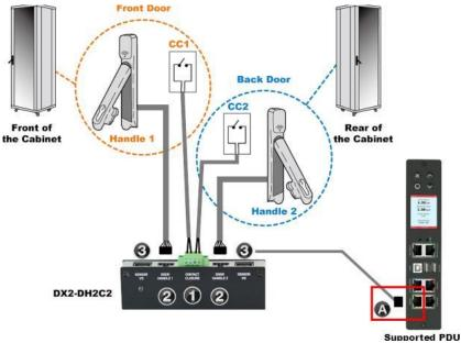
SmartLock Kit Quick Setup Guide - DX2-DH2C2 SmartLock\_DX2DH2C2\_QSG\_A2\_4.0.20 • 255-90-0006-00
